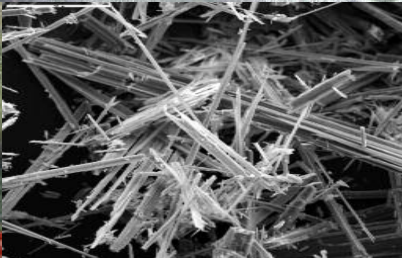
Beim Umgang mit Asbest, Glaswolle und Steinwolle können lungengängige Partikel freigesetzt werden. Von den Partikeln gehen erhebliche Gesundheitsgefahren aus. Auf dem Foto oben macht die Reflexion solche Partikel für das Auge sichtbar.
